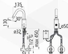
Rubinetto elettronico con "DMP Infrared Sensor" antigraffio e anticalcare
