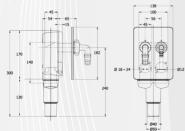
Sifone in PP ad incasso ispezionabile con 2 attacchi elettrodomestici, piastra in acciaio inox e porta gomma bianchi.
