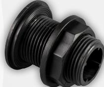
**bj BUCCHI** Una estremità maschio filettata ed una munita di collare di serraggio e guarnizione Piana in EPDM. Guarnizione spessa per compensare le ondulazioni della parete del contenitore. Pressione di esercizio: 10 bar a 20°C. Standard di connessione: Filettatura esterna GAS cilindrico UNI ISO 228/1. Temperatura massima di esercizio: 80°C. Materiali: Polipropilene (PP) EPDM Colori: Nero (RAL 9011)
