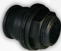
**bj BUCCHI** Guarnizione spessa per compensare le ondulazioni della parete del contenitore. Pressione di esercizio: 10 bar a 20°C. Standard di connessione: Filettatura esterna GAS cilindrico UNI ISO 228/1. Temperatura massima di esercizio: 80°C. Materiali: Polipropilene rinforzato con fibra di vetro, EPDM, NBR, Gomma siliconica FPM. Colori: Nero (RAL 9011)
