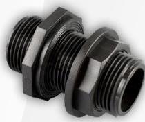
**bj BUCCHI** Una estremità maschio filettata ed una munita di collare di serraggio e guarnizione Piana in EPDM per fissare un portagomma dritto o curvo. Guarnizione spessa per compensare le ondulazioni della parete del contenitore. Pressione di esercizio: 10 bar a 20°C. Standard di connessione: Filettatura esterna GAS cilindrico UNI ISO 228/1. Temperatura massima di esercizio: 80°C. Materiali: Polipropilene (PP) EPDM Colori: Nero (RAL 9011)
