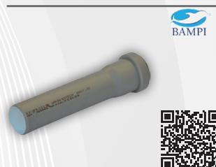
Vendibile solo a confezione. Tubo dotato di bicchiere d'innesto con guarnizione elastomerica monolabbro preinstallata (DIN EN 681 e DIN 4060). Tubi in PP-H/MD/PP-H. I materiali che compongono il sistema BAMPLAST PP-TECH sono completamente riciclabili e realizzati in assenza di alogeni, cadmio e metalli pesanti. La temperatura del fluido evacuato all'interno del sistema può raggiungere per un breve periodo di tempo i 98°C, mentre per il lungo periodo la temperatura può raggiungere i 95°C.
