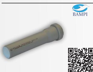
Tubo dotato di bicchiere d'innesto con guarnizione elastomerica monolabbro preinstallata (DIN EN 681 e DIN 4060). Tubi in PP-H/MD/PP-H. I materiali che compongono il sistema BAMPLAST PP-TECH sono completamente riciclabili e realizzati in assenza di alogeni, cadmio e metalli pesanti. La temperatura del fluido evacuato all'interno del sistema può raggiungere per un breve periodo di tempo i 98°C, mentre per il lungo periodo la temperatura può raggiungere i 95°C.
