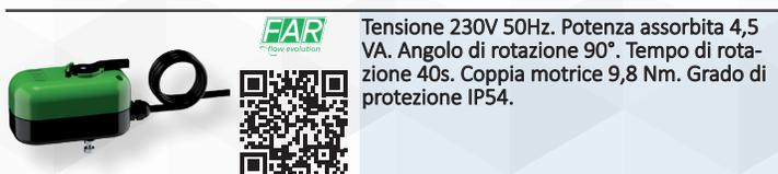
Tensione 230V 50Hz. Potenza assorbita 4,5 VA. Angolo di rotazione 90°. Tempo di rotazione 40s. Coppia motrice 9,8 Nm. Grado di protezione IP54.
