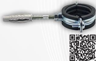
Materiali: nastro acciaio DD11 EN 10111; acciaio S235JR UNI EN 10027-1; zincatura elettrolitica; gomma EPDM; nylon PA6. Collare isofonico, viti laterali, controdado, vite di congiunzione doppio filetto, tassello TX4 in nylon PA6. Per il fissaggio di tubazioni con prestazioni isofoniche e di isolamento termico.
