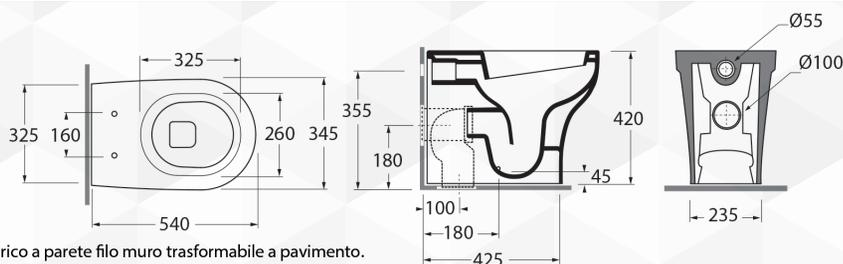
Vaso Pratica con scarico a parete filo muro trasformabile a pavimento.
