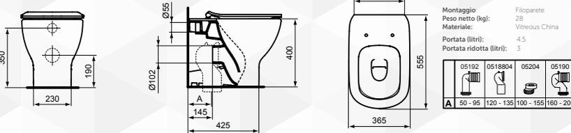
Grazie allo scarico traslato che copre distanze dal muro comprese tra 150 e 200 mm (attraverso le apposite curve tecniche da ordinare separatamente) può essere installato senza dover apportare modifiche agli impianti esistenti. Installazione filo parete. Il vaso è corredato di fissaggi a pavimento. Certificato per scarico 4,5/3 litri.
