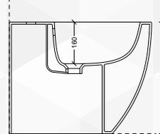
RANGE UTEZZA ACQUA: MONTAGGIO STANDARD RANGE MIN 100 MAX 160 mm
