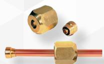
Il nuovo raccordo autocartellante sostituisce le tradizionali cartelle realizzate a mano. Composto da un dado e una boccola di compressione con bussola già inserita, elimina l'uso del calibratore. Universale per i tubi di rame spessore 0,80 e 1 mm. Garantito e testato a 240 bar di pressione, è utilizzabile con qualsiasi gas refrigerante.
