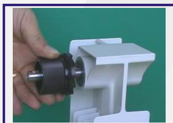
2: Pulizia e spiantatura della flangia di accoppiamento del radiatore.
