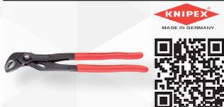
In acciaio al cromo vanadio, forgiato, temperato ad olio, bonderizzata grigia, testa pulita. Cerniera passante, con regolazione mediante pressione sul pulsante. Manici rivestiti in resina sintetica antiscivolo.
