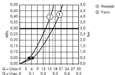
I valori di consumo sono stati misurati nella pratica con le armature appartenenti (Termostato/ Miscelatore/Valvola sotto-intonaco).
