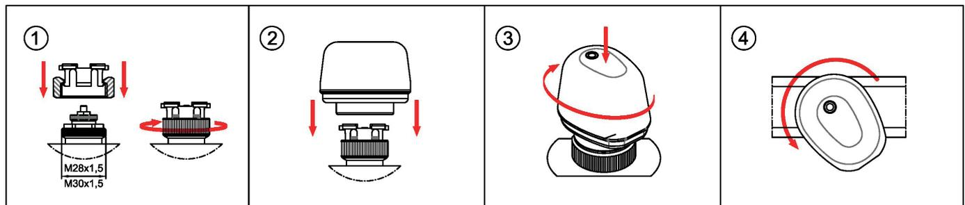
1. Togliere il cappuccio bianco presente sulla valvola o sul vitone della barra collettore. Inserire l'aggancio rapido sul vitone e avvitare la ghiera fino a fine corsa.
