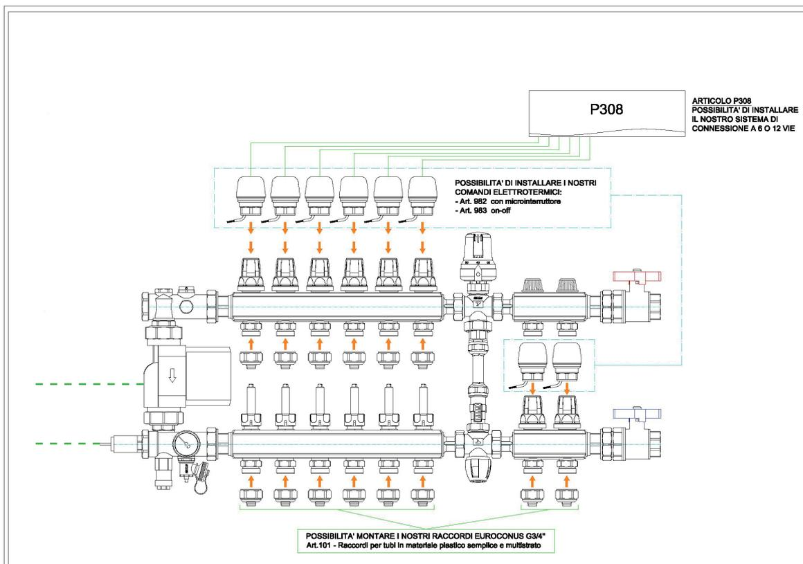
Esempio di installazione su valvole di zona per impianto a radiatori
