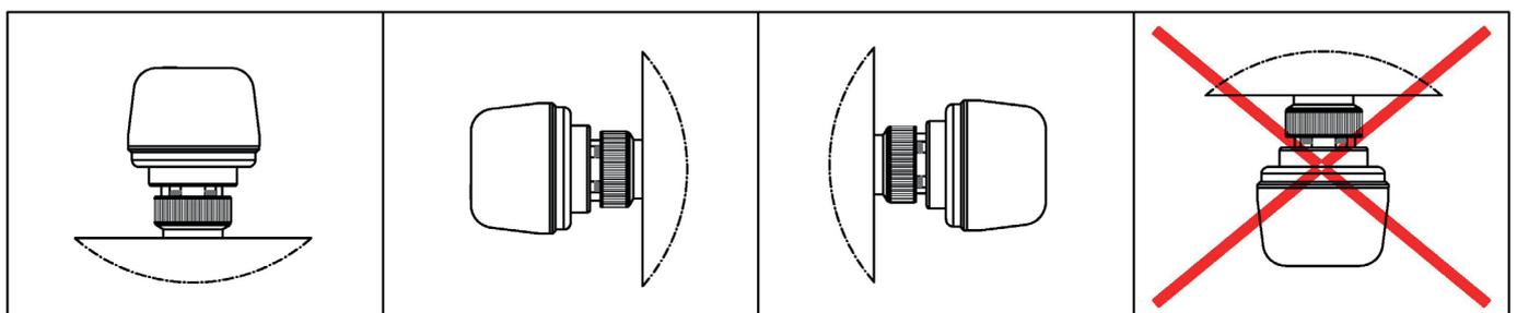
Si consiglia l'installazione degli attuatori elettrotermici in posizione orizzontale o verticale, mai rovesciata! La possibile formazione di condensa sulle valvole e sui collettori potrebbe scendere sul comando e danneggiarlo.
