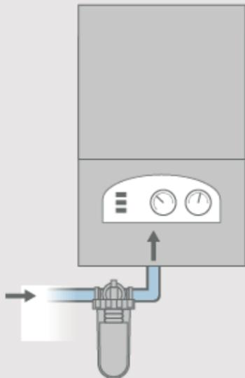
Il Dosaphos 250 TWIST si differenzia dal 200 per la dotazione del dispositivo ACQUASTOP (by-pass integrato) che consente di essere in regola con il D.M. 443/90 senza realizzare (come previsto obbligatoriamente) il by-pass di esclusione dell'impianto.
