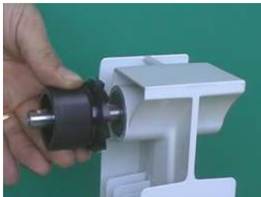
2: Pulizia e spiantatura della flangia di accoppiamento del radiatore.
