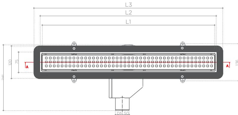
NOTA: Gli scarichi di lunghezza 550 e 650 sono forniti in confezione con due serie di gambe per la regolazione dell'altezza. Gli scarichi di lunghezza 750 sono forniti in confezione con quattro set di gambe per la regolazione dell'altezza.
